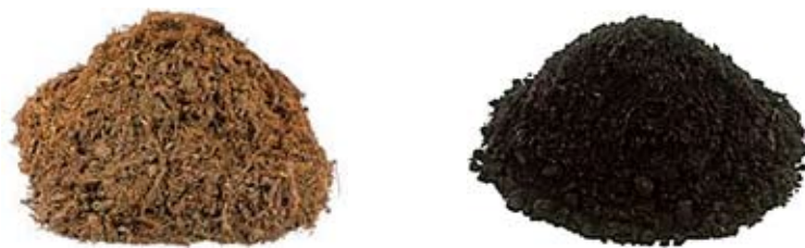
Kuva 1. Kokeissa tutkittiin kasvuturpeen (vasen) ja kompostin (oikea) seoksia (kuvat Vapo).
