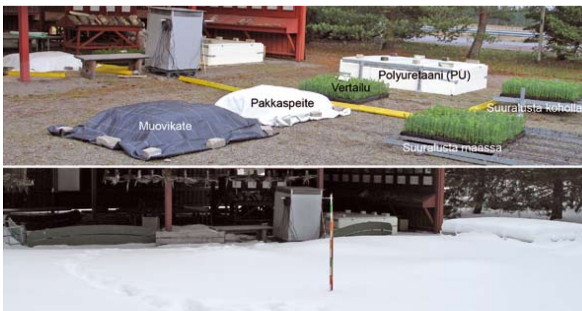
Kuva 1. Talvikaudella 2008/09 toteutettu koe. Etualalla taivasalla olevat käsitteilyt ja takana katoksessa lumettomina pidetyt käsitteilyt sekä mittauskoju. Yläkuvassa tilanne 30.10.2008 ja alakuvassa 2.3.2009.
