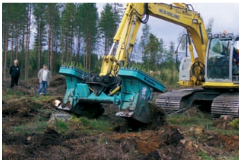
Kuva 1. M-Planter istutuskoneen istutusputkissa on kaksi mätästyslevyä ja niissä istutusputket. (kuva Marja Poteri).
