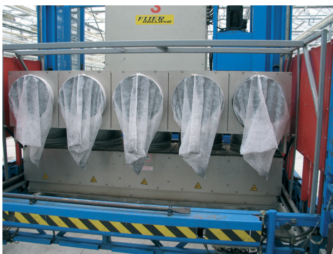
Kuva 7. Florensin tarhalla oltiin tyytyväisiä itserakennettuun hyönteisimuriin. Laite kulkee kasvustojen yläpuolella ja poistaa sieltä lähinnä lentäviä harsosääskiä imemällä ne pusseihin. (Kuva Risto Rikala).
