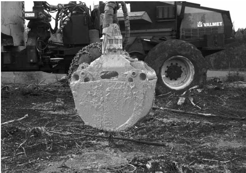
Kuva 2. Vanhoista kaivinkoneen kauhoista tehty Asa-Mockan ”mättäiden” tekemiseen kehitetty kauha.
