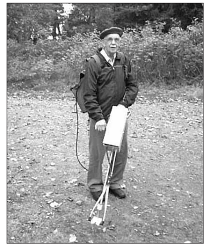
Kuva 3. Tukkimiehentäin torjunta-aineen maastolevitykseen kehitetty akkukäyttöinen ruisku ja sen kehittäjä Erik Sandberg.
