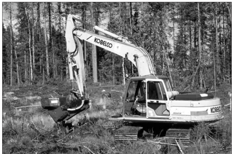
Kuva 1. Kaivukoneeseen asennettu Bräcke-istutuskone.
