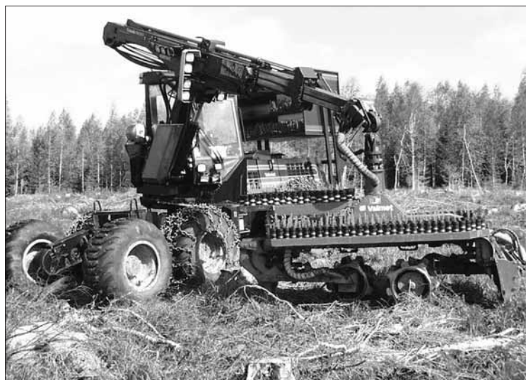
Kuva 2. Hakkuukoneeseen asennettu Ecoplanter-istutuskone.
