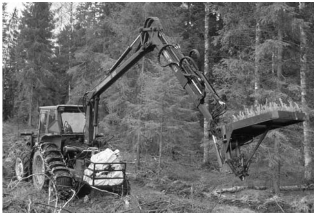
Ilves-istutuslaite maataloustraktoriin liitettynä.
