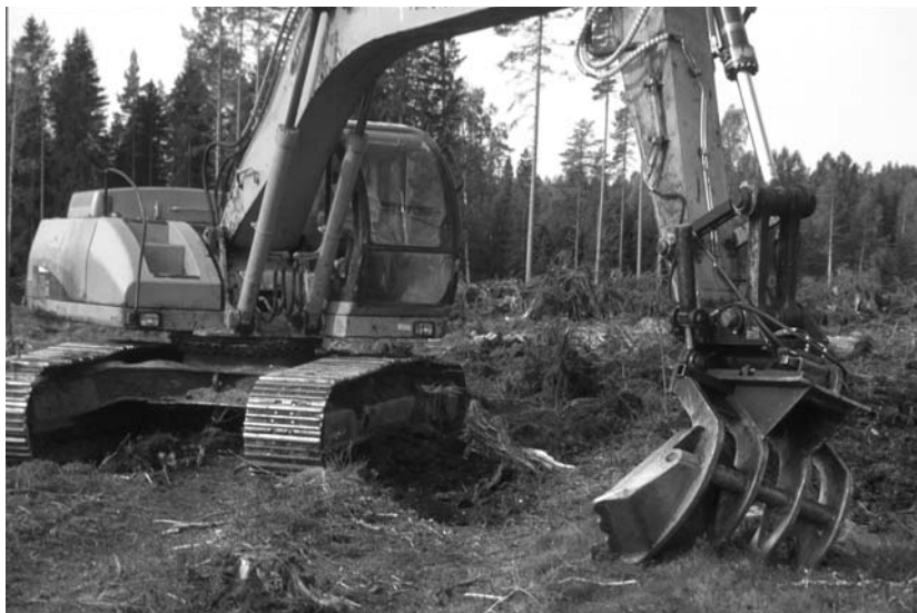
Kuva 2. Kantojen nostoon soveltuva hara kiinnitettynä kaivurin kauhan tilalle.
