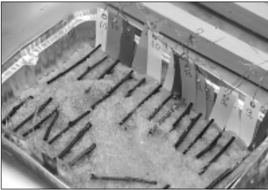
Kuva 2. Rangan rusketumistestin näytteitä kvartsihiekkapedillä, jossa näytteitä 'kasvattiin' 2 viikkoa ennen pakkasvaurioiden arviointia. Hiekan pinta pidettiin koko ajan kosteana, mutta ei märkänä.
