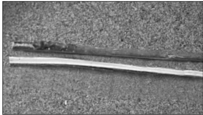
Kuva 3. Halkaistu pakkasaltistettu näyte rangan rusketumistestissä.
