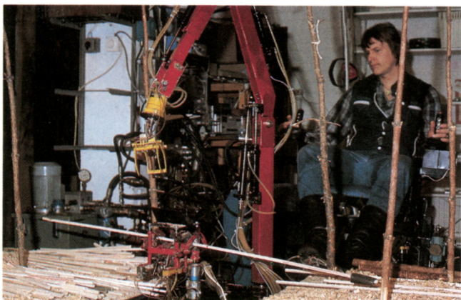
Der Forstmaschinensimulator in der Forschungsstation Suonenjoki untersucht neue Maschineninnovationen, Fahrerschulung und ergonomische Probleme.
