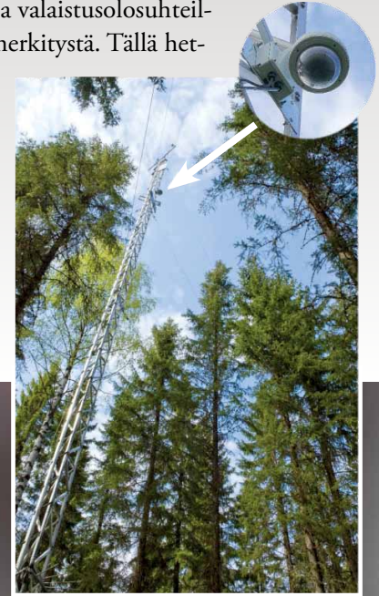
Digitaalikamera kiinnitettynä sääsemaan eli säätorniin.
