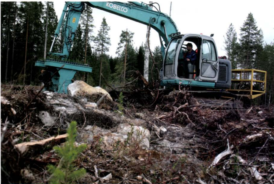
Kuva 33. M-Planter istutuskone, jossa on kaksi muokkaus- ja istutus päätä.
