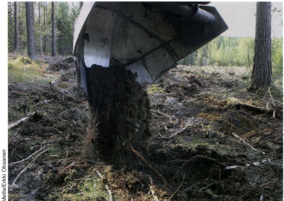
Kuva 15. Kääntömätästyksen työvaihteita. Yläkuvassa kääntömätästyksen kehitetyn kauhan kärjellä otetaan tarvittava maakerros. Alakuvassa kauha kääntää otetun maan ylösalaisin samaan kuoppaan, jolloin humus tulee pohjalle ja kivennäismaa pinnalle.
