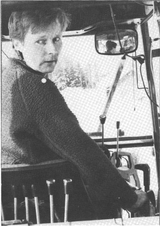
Figur 12. Rygging med konvensjonell traktor. Bildet viser en typisk arbeidsstilling. Overkroppen er vridd i ytterstilling. Samtidig betjenes både pedaler, spaker og ratt.
