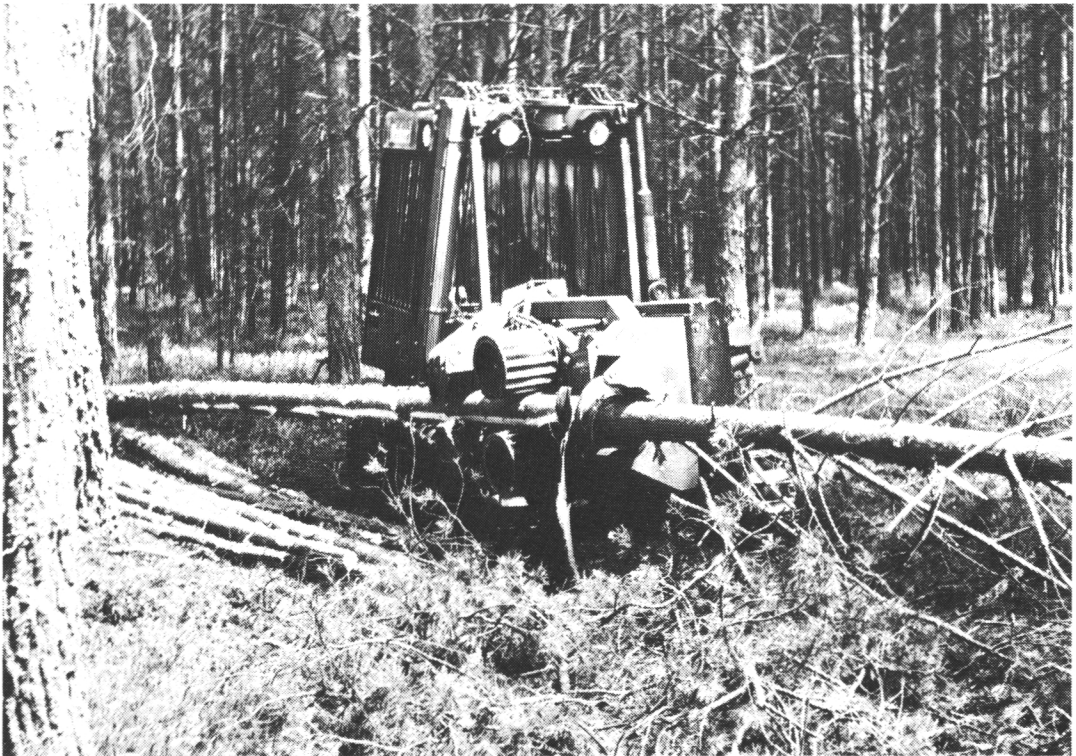
Figure 8. The Makeri harvester in stand 4. Delimiting and bucking a tree. Kuva 8. Makeri harvesteri metsikössä 4. Puun karsiminen ja katkominen. Fot. 8. Harvester Makeri na powierzchni 4. Okrzesywanie i przerzynka drzewa.
