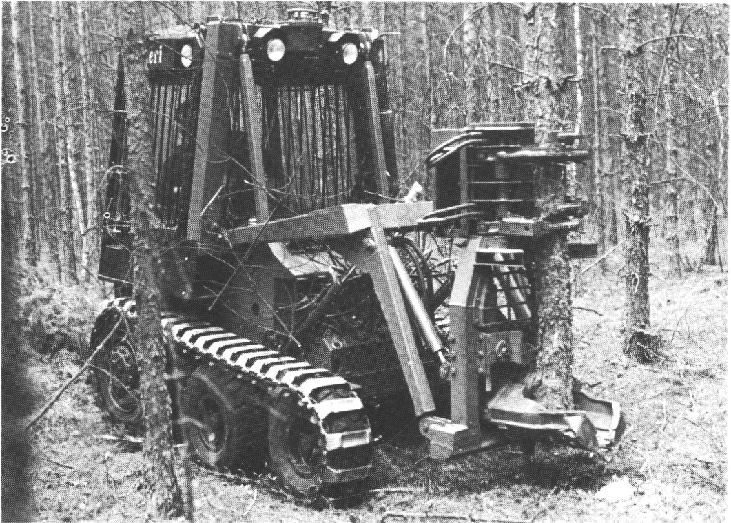
Figure 7. The Makeri feller-buncher in stand 3. Kuva 7. Makeri kaato-kasauskone metsikössä 3. Fot.7. Maszyna ścinkowo-układająca Makeri na powierzchni 3.
