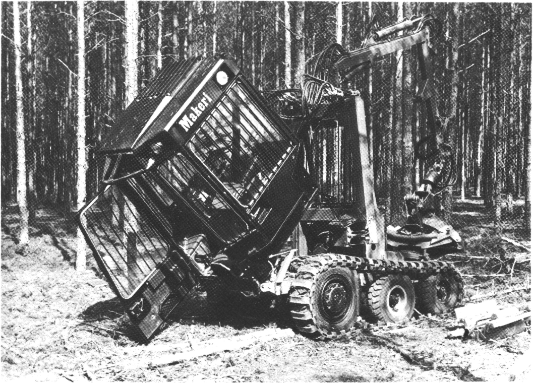
Figure 1. Tipping the cabin aside to service the Makeri tractor. Kuva 1. Makerin ohjaamo voidaan kääntää syrjään huollon ajaksi. Fot 1. Przechylna kabina ułatwia obsługę ciągnika Makeri.
