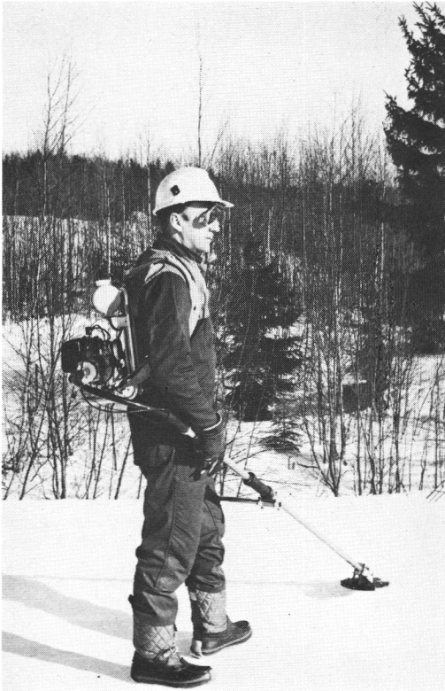
Kuva 3. Tas QUM-2 raivaussaha on rakenteeltaan poikkeava. Moottoria kannetaan selässä ja voimansiirtoakseli on taipuisa. Fig. 3. Tas QUM-2 is an unusual clearing saw. The engine is carried on the operator's back and the drive shaft is flexible.
