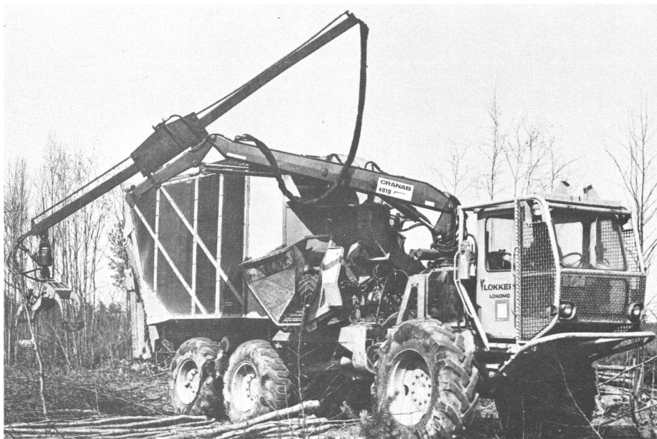
Kuva 11. TT 1000 F palstahakkuri pienikokoista leppää korjaamassa. Figure 11. The TT 1000 F terrain chipper harvesting small-sized alder.
