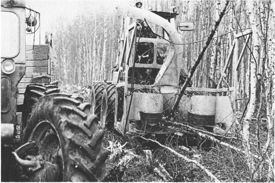
Kuva 14. Pallarin vesakkoharvesterin prototyyppi pientä hieskoivua hakettamassa (kuva Oy W. Rosenlew Ab). Figure 14. The prototype Pallari Bushharvester chipping small-sized white birch (Photo Oy W. Rosenlew Ab).
