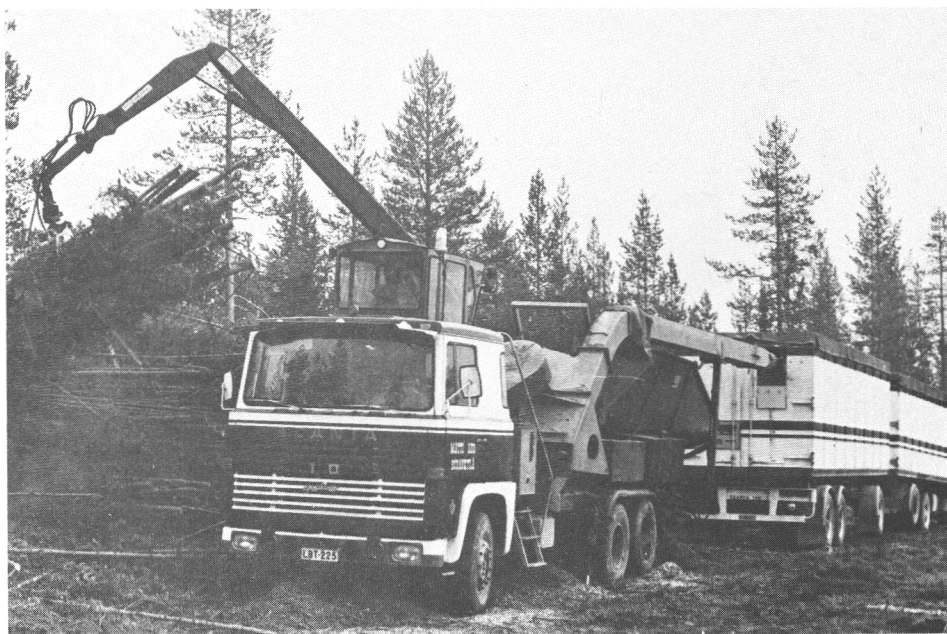
Kuva 12. TT 1500 L välivarastohakkuri puhalttaa polttohakkeen suoraan täysperävaunulliseen kuorma-autoon. Figure 12. The TT 1500 L landing chipper blows the fuel chips straight onto a truck with semitrailer.
