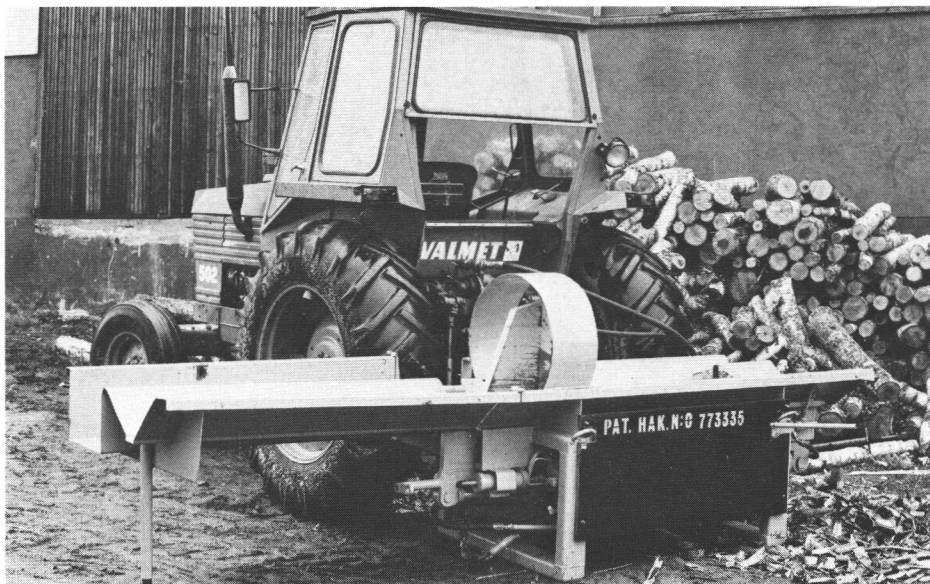
Kuva 5. Maataloustraktoriin sovitettu Hako halkaisu- ja aisauskone (kuva Orasvuon Konepaja Ky). Figure 5. Hako splitting device mounted on a farm tractor (Photo Orasvuon Konepaja Ky).
