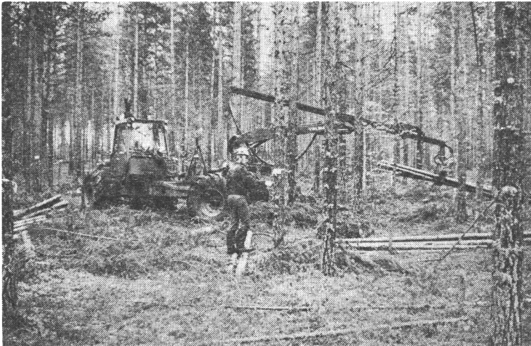
Kuva 1. Marttiin liukupuomilla varustettu kuormatraktori sekä Valmet-esikasauskoneet II ja III Fig. 1. Forwarder equipped with Marttiin's slide-boom and Valmet preliminary skidding machines II and III
