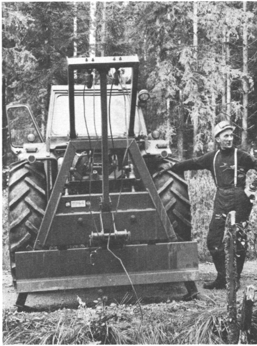
Kuva 7. Vintturin vetopisteen korotus ja siihen asennettu puskulevy. Figure 7. Raising of the traction point of the winch and the push plate installed in it.
