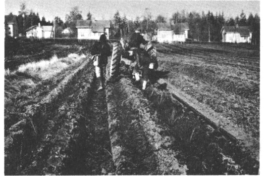
Kuva 10. Penkeiksi kynnettyä peltoa Anjalassa. Istutus suoritetaan Heger-koneella penkin päälle. Photo 10. A bedded field at Anjala. Planting is done on the beds using a Heger tree planter.
