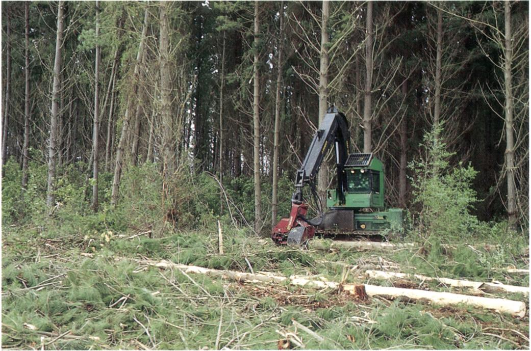
Figura 14. Cosechadora Timberjack 2618 con orugas dotado de un cabezal de corta Waratah 230HTH.
