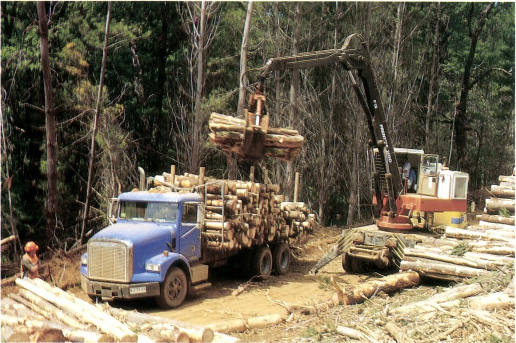
Figura 11. Trabajo de carga de un camión maderero empleando un cargador individual.
