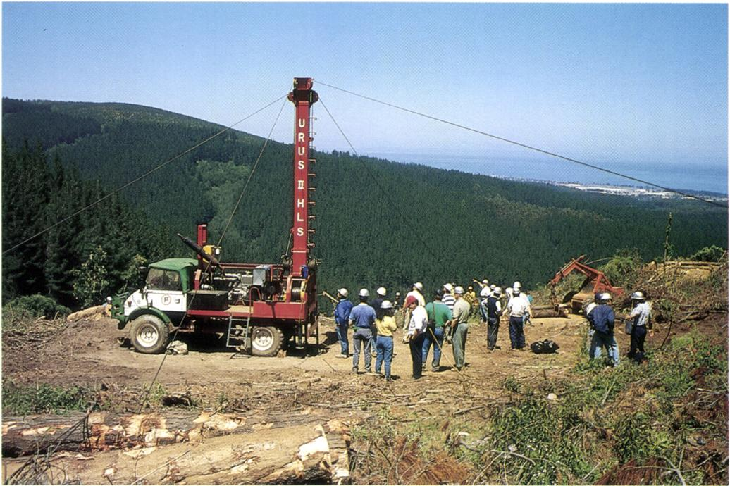
Figura 10. Cable aéreo fijado al chasis de un camión y un tractor apilador de tres ruedas.
