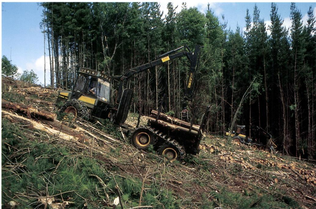
Figura 18. Tractor autocargable forestal Ponsse S15 operando en el área de investigación. La inclinación de la pendiente fue de un 35 %.
