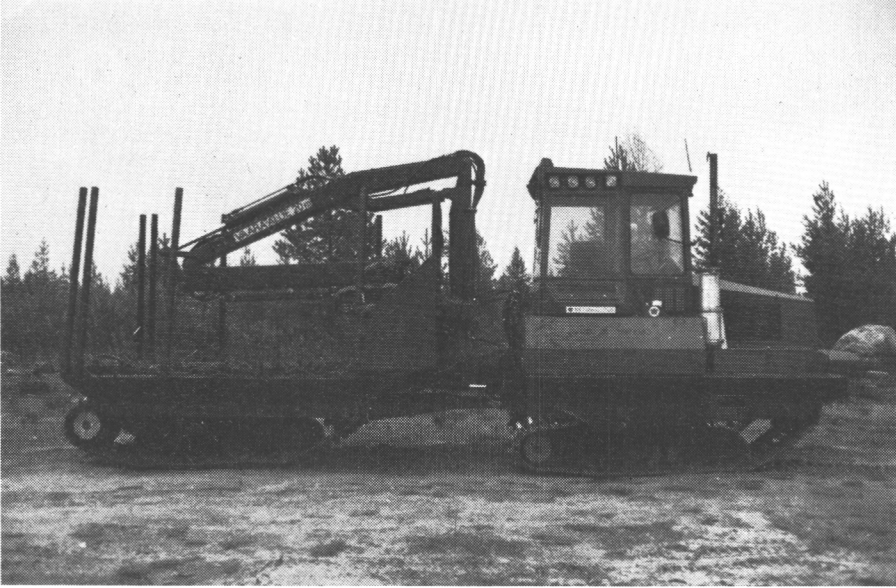
Kuva 7. Komponenteista Suokone Oy:n omaan runkoon koottu Meri Trackmo 160.
