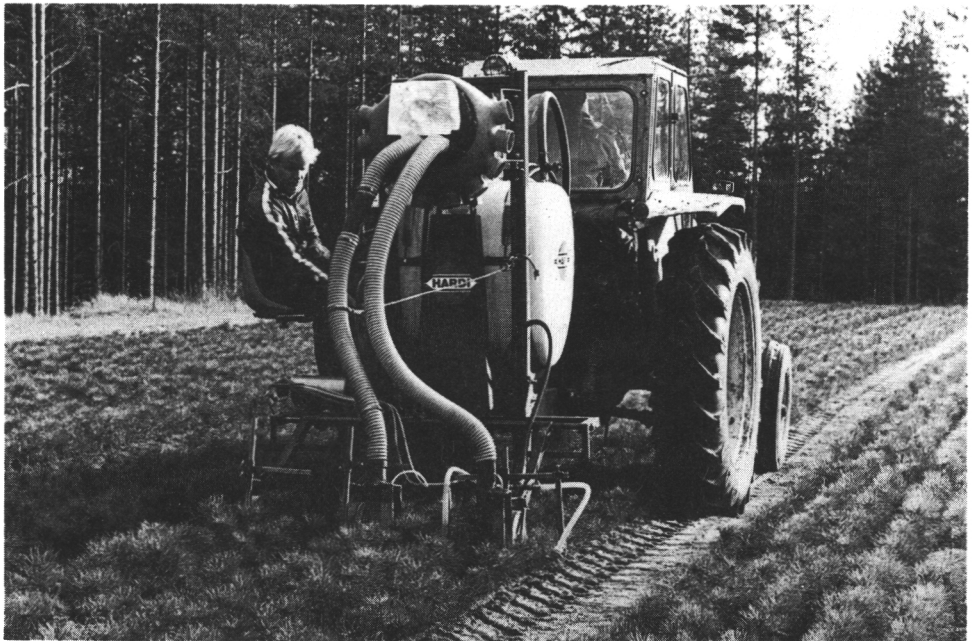
Kuva 2. Kehitetty ruiskutus- ja taimesta ohi menevän aineen keräyslaitteisto (laitteisto 2).
