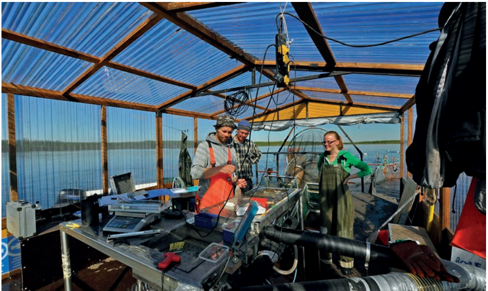
Kuva 5. Lohen ja taimenen vaelluspoikasten pyyntiin käytettävä rysä ja rysän perässä oleva ponttonien päällä oleva koentalautta Tornionjoen alaosalla. Lautalla on kalojen käsittelyä varten muun muassa kiertovesijäähdytetyt ja hapetetut nukutusaltaat. Kuva: Ville Vähä.
