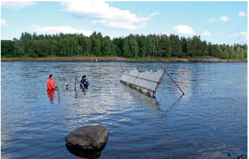
Kuva 9. Luotaimet sijaitsevat Kattilakosken niskalla, joen molemmilla rannoilla. Niiden välinen etäisyys on noin 150 metriä, vedenkorkeudesta riippuen. Kuva: Mikko Leminen.
