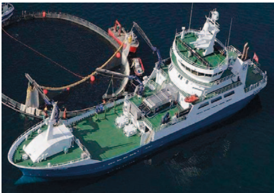
Kuva 21. Avomerilaitosten yleistyessä ja koon kasvaessa on tullut tarvetta jopa yli 40-metrisille aluksille ja suuremmille nostureille sekä kantavuudelle; oikealla merikelpoinen nopea huolto/tarkastusvene (kuva: Ace AquaCulture Engineering).
