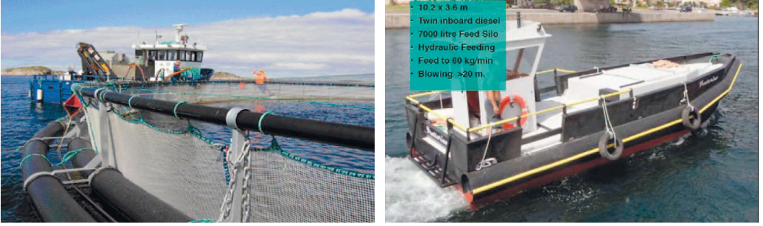
Kuva 16. Ruokintaveneet saattavat olla riskittömämpi ja kustannustehokas ratkaisu avoimilla alueilla. Rehu puhalletaan kasvatusalueille ilman avulla. Vasemmalla ruokintajärjestelmä on asennettu katamaraani-työveneeseen, oikealla Refa Medin rehuvene (kuva: Refa Med Srl).
