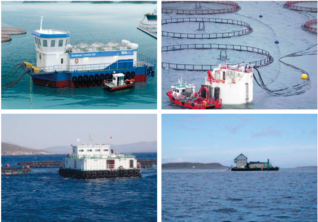
Kuva 15. Erilaisia ruokintalauttavaihtoehtoja. Esimerkiksi AKVA group -yhtiön ruokinta-alusten kapasiteetti on 100–700 tonnia rehua (vasen yläkuva) (kuva: AKVA group). Alukset räätälöidään tuotantomäärien mukaan ja valmistetaan Tallinnassa. Alhaalla vasemmalla on ruokin-talautta Turkista, oikealla Norjasta (kuva: RKTL).
