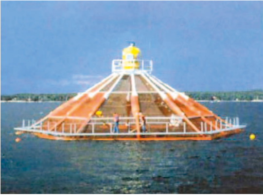
Kuva 8. Tiettävästi ensimmäinen puoliksi upotettava (semi submergable) Farmocean-laitos valmistettiin Ruotsissa 1986, ja niitä on ollut maailmanlaajuisesti käytössä sen jälkeen ainakin 40 kpl. Kehikon päällä on ruokinta-automaatti, jota voidaan ohjata rannasta (kuva: Farmocean).
