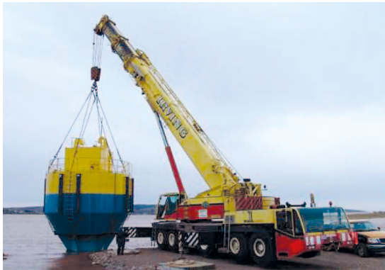
Kuva 18. New Hampshiren yliopistossa on kehitetty automaattinen ruokintapöjju, jossa rehu välittyy veden mukana upotettaville kasvatusalustoille (kuva: Ocean Farm Technology).
