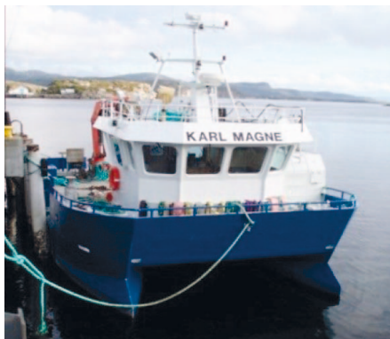
Kuva 19. Norjassa merilaitoksilla on käytössä yleisesti leveä katamaraani-työvenetyyppi, jolla on noin 20 tonnin kantavuus. Perässä on yksi tai useampi nosturi, joilla voidaan nostaa rehusäkkejä ja verkkoja (kuvat: RKTTL, AKVA group).
