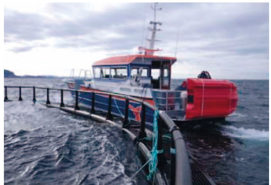
Kuva 21. Avomerilaitosten yleistyessä ja koon kasvaessa on tullut tarvetta jopa yli 40-metrisille aluksille ja suuremmille nostureille sekä kantavuudelle; oikealla merikelpoinen nopea huolto/tarkastusvene (kuva: Ace AquaCulture Engineering).
