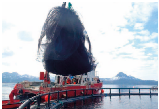
Kuva 19. Norjassa merilaitoksilla on käytössä yleisesti leveä katamaraani-työvenetyyppi, jolla on noin 20 tonnin kantavuus. Perässä on yksi tai useampi nosturi, joilla voidaan nostaa rehusäkkejä ja verkkoja (kuvat: RKTTL, AKVA group).
