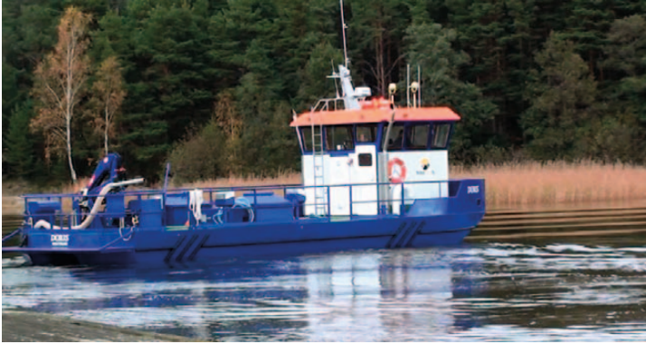
Kuva 20. Uudessakaupungissa valmistetussa katamaraanipohjaisessa työveneessä on ruokintajärjestelmä sekä vinssi verkkojen ja rehujen nostamiseen (kuva: Rami Salminen, Sybimar Oy).
