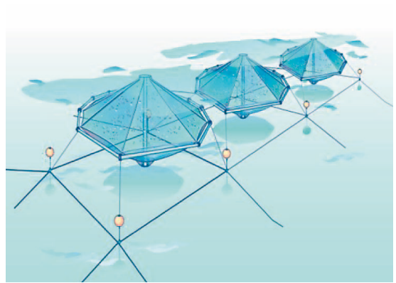
Kuva 9. Yhdysvaltalaisen OceanSpar-yhtiön SeaStation perustuu altaan keskellä olevaan lieriöön tai poijuun, jonka päihin kiinnitettävien vajereiden ja keskellä olevan upotetun ympyrän muotoisen kehikon varaan verkkoallas pingotetaan. Ainakin 25 järjestelmää on myyty, muun muassa Puerto Ricoon ja Havaijille (kuva: OceanSpar).
