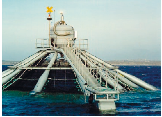
Kuva 8. Tiettävästi ensimmäinen puoliksi upotettava (semi submergable) Farmocean-laitos valmistettiin Ruotsissa 1986, ja niitä on ollut maailmanlaajuisesti käytössä sen jälkeen ainakin 40 kpl. Kehikon päällä on ruokinta-automaatti, jota voidaan ohjata rannasta (kuva: Farmocean).
