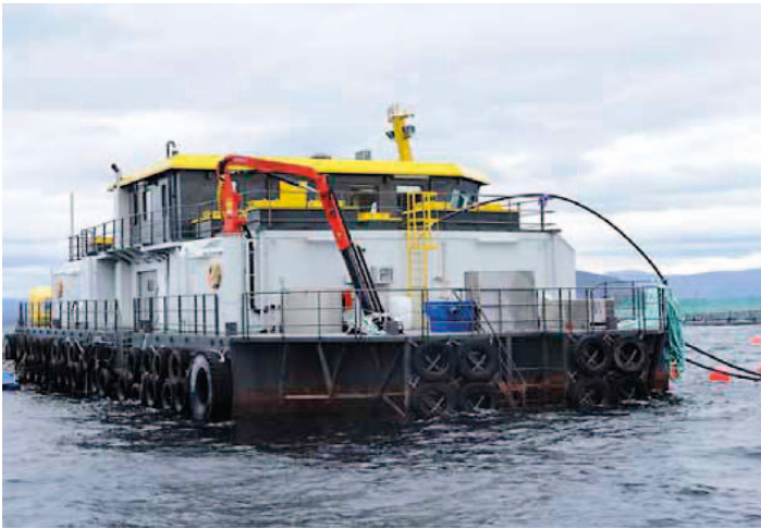
Kuva 3. Edityksellisissä ruokintalautoissa on suuret rehusiilot, energiantuotanto, ruokinnanohjaus sekä tuotantotarkkailujärjestelmät ja oleskelutilat henkilöstölle.
