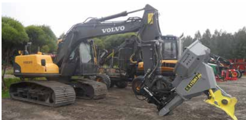
Рис. 13. Лесопосадочное устройство Bracke, установленное на оконечность стрелы базовой машины. Фото: Микаэль Кукконен
