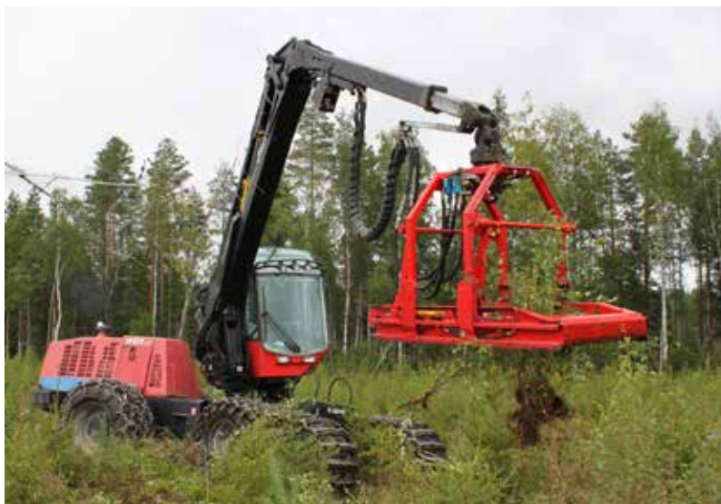
Рис. 19. Устройство для механизированного осветления Naarva P25. Фото: Pentti Paja Oy
