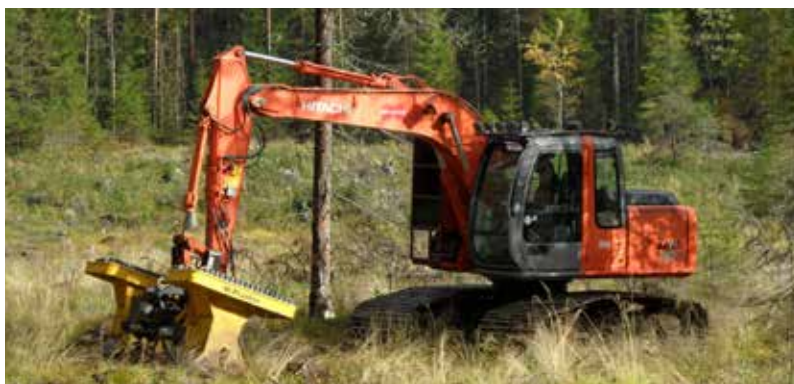
Рис. 14. Лесопосадочное устройство M-Planter с двумя посадочными головками, установленное на экскаваторе. Фото: Микаэль Кукконен
