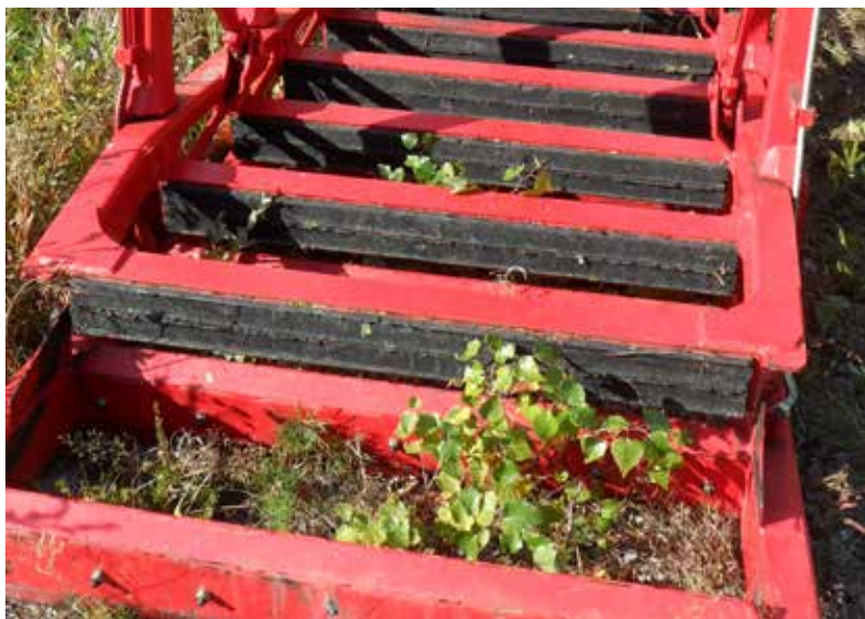
Рис. 20. Во время операции захвата верхняя рама устройства перемещается примерно на 30 см, прижимаясь к нижней раме, поэтому самые короткие лиственные деревья можно захватить только в том случае, если они будут находиться вблизи захвата нижней рамы.
