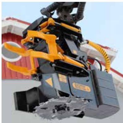
Рис. 21. Устройство для заготовки топливной древесины Risutec, которое подходит также и для ухода за молодым древостоем.
