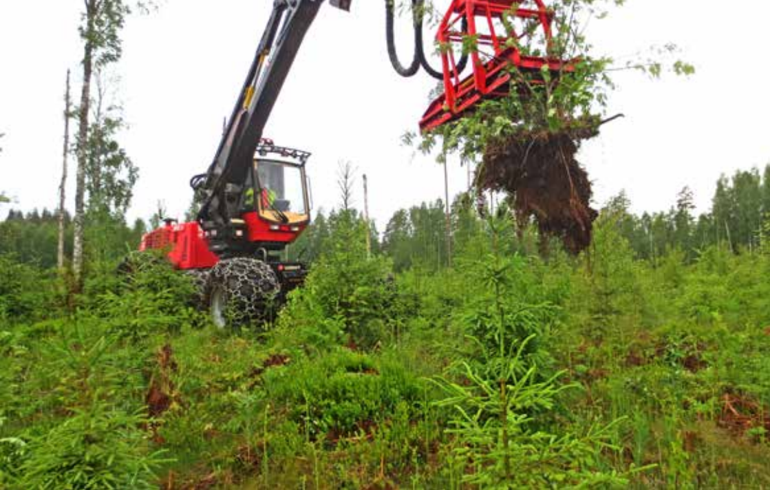
Рис. 4. При проведении механизированного осветления деревья лиственных пород вырываются из почвы с корнем с помощью устройства Naarva P25 компании Pentin Paja Oy. Фото: Микаэль Кукконен
