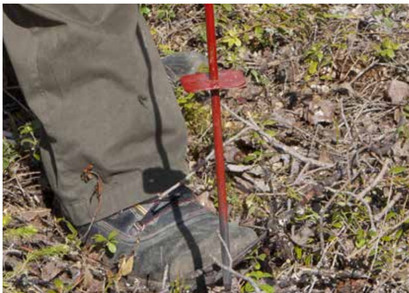
Рис. 2. Каменистость почвы на объекте измеряется с помощью механического щупа. Фото: НИИ леса Финляндии Metla
