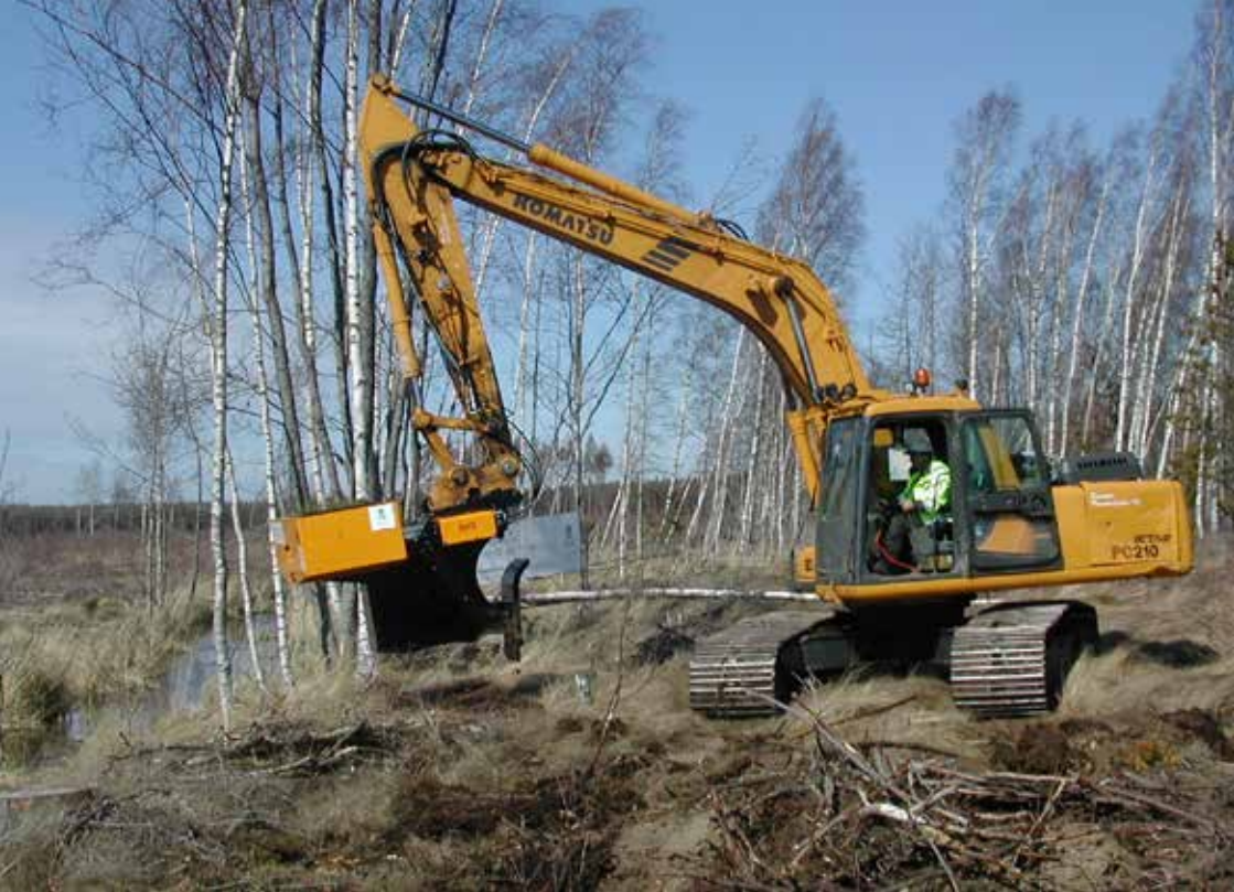
Рис. 12. Лесопосадочное устройство Risutes, установленное на экскаваторе. Фото: Юсси Айкала
