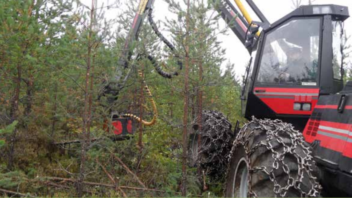
Рис. 10. Уход за молодым древостоем с помощью режущей головки MenSe. Фото: Микаэль Кукконен
