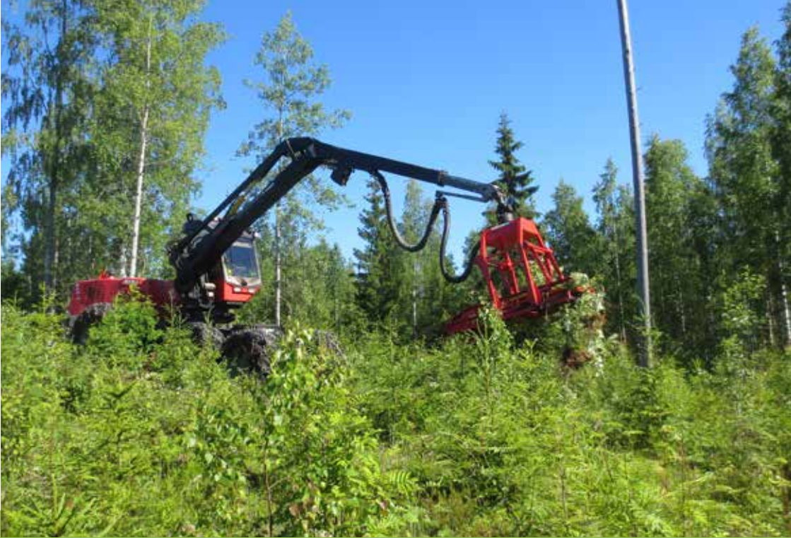
Рис. 1. Во время механизированного удаления нежелательной растительности деревья, мешающие росту целевого молодняка, вырывают из земли с корнем. Фото: Микаэль Кукконен
