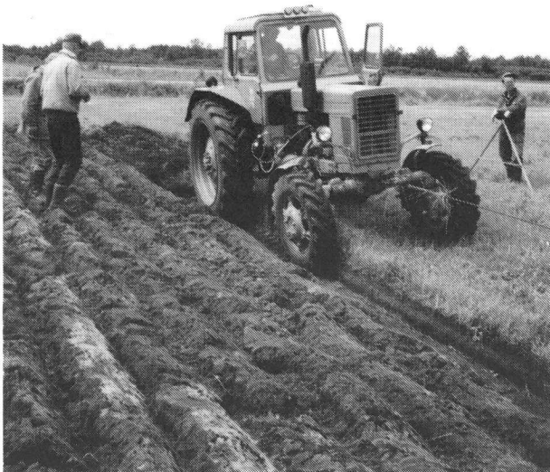
Aurojen vetovastus ja traktorin polttoaineen kulutus kynnessä mitattiin Kuusikun valtioneuvoston pellolla.
