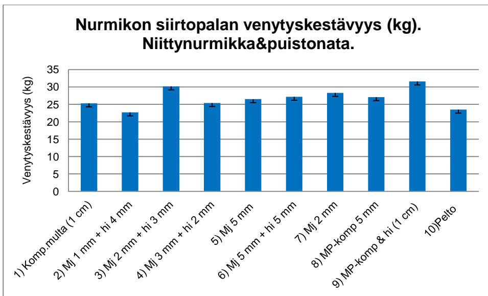
Kuva 15. Niittynurmikka-puistonadan siirtonurmikkopalojen venytyskestävyys (kg) murtumiskokeessa. Kasvustot oli perustettu 8.7.2010 ja nostettu 10.10.2011. Jana kuvaa keskihajonnan suuruutta. n=4.
