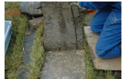
Kuva 4. Siirto poisti peltoon lisätyn mädätysjäännöksen. Siirtopalaan tuli mukaan myös hieman peltomaata.
