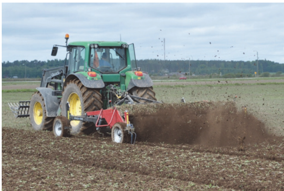
Kuva 1. Kvick-Finn koneen toimintaperiaate. Maata irroittavat kultivaattorin piikit on kiinnitetty mustaan runkoon. Punaisessa rungonosassa oleva tiheäpiikkinen roottori heittää pintamaan ja rikkakasvien juuret ilmaan. Kuva: Timo Lötjönen.
