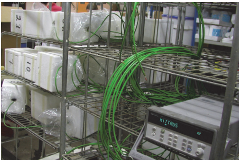
Kuva 10. Aerobisen stabiilisuuden mittalaitteeseen kuuluu dataloggeri, joka tallentaa termoparikaapelien havaitsemat lämpötilamuutokset. Kukin kaapeli menee yhteen polystyreenilaatikkoon, jonka sisällä on tutkittava rehunäyte. Kuva: Arja Seppälä.
