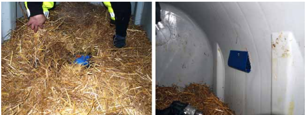
Kuva 6. Iglujen sisäseinään ja pehkuun upotettujen lämpötilamittareiden asennukset.
