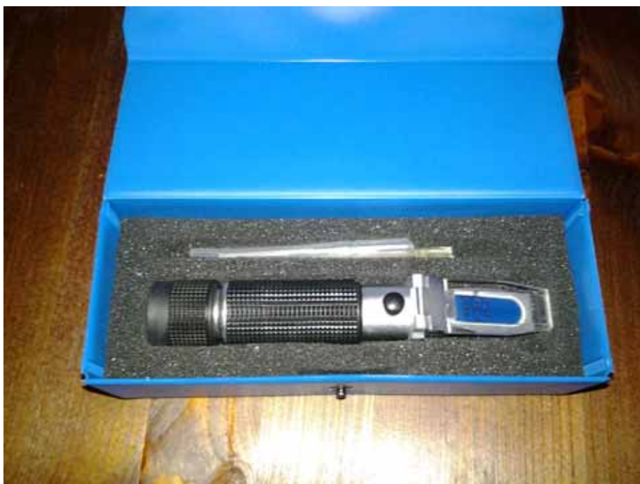
Kuva 1. Tutkimuksessa tutkittiin 1206 ensimmäisen lypsyn ternimaitonäytettä kuvassa olevalla Brix-32%-refraktometrillä (EUROMEX RF.5532, Hollanti). Ternimaitoa tiputettiin valolevyn alle viisi tippaa, levy asetettiin tasaisesti maidon päälle ja tulos luettiin Brix%-asteikolta katsomalla refraktometrillä valonlähdettä kohden. Kuva: Marja Viitala.
