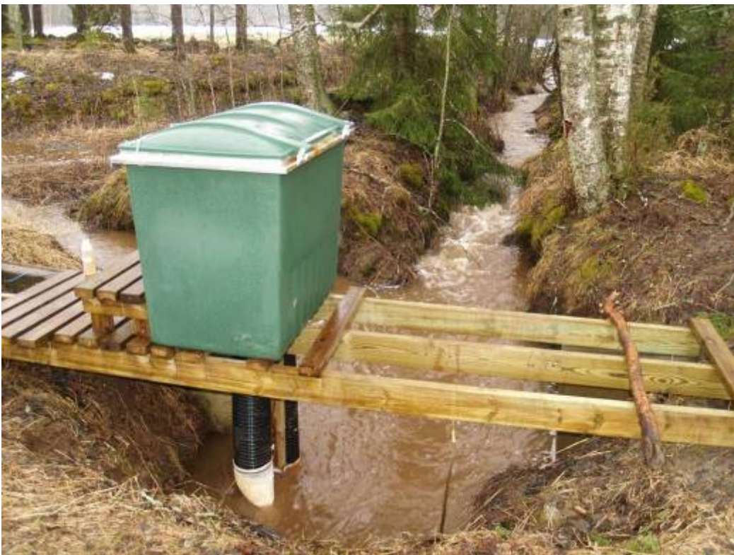
Kuva 6. Kahdella annostelusuppilolla varustettu suurin annostelija (Kohde 2).
