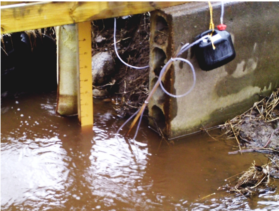
Kuva 9. Riistakameran ottama kuva kohteen 2 ojaveden pinnankorkeudesta. Musta kanisteriin kerättiin kokoomänäytettä ajastimella toimivan pumpun avulla.
