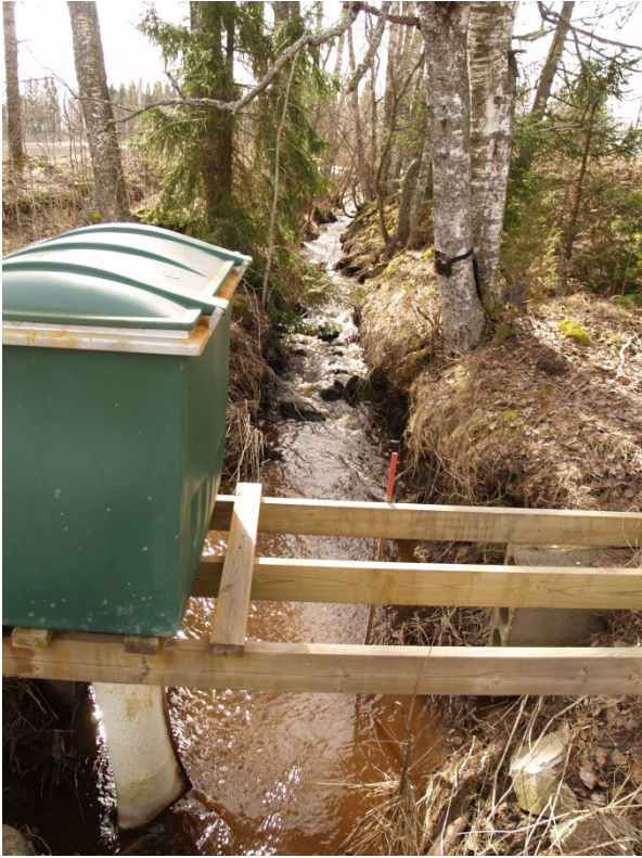
Kuva 8. Kaksi annostelusuppiloa korvattiin yhdellä pitkällä annostelusuppilolla 2013. Taustalla näkyy koivun runkoon ripustettu riistakamera.
