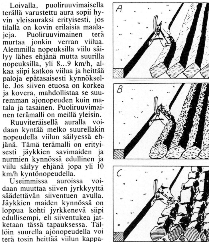
Piirros 9. Siiven mallin vaikutus kyntöjälkeen. A ruuviterä, B puoliruuviterä ja C lieriöterä (Häggblom, S., Svensson, K. 1972).
