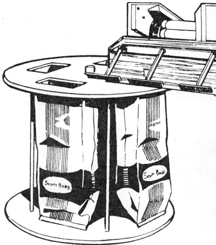
Kuva 15. Neljällä aukolla varustettu "säkitysruletti" helpottaa tuntuvasti säkkien vaihtoa.
