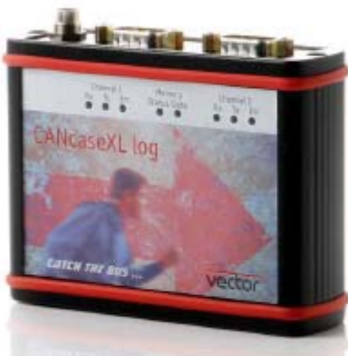
Kuva 3 CAN-liitäntäyksikkö, jolla voi lukea ja tallettaa tietoa kahdelta CAN-väylältä. ( http://vector.com/portal/medien/cmc/datasheets/CANcaseXL_log_DATASHEET_EN.pdf )
