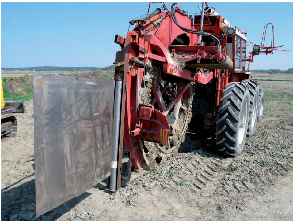
Kuva 14. Ylhäällä vasemmalla muovikalvon asentaminen 1,8 m:n syvyyteen. Ylhäällä oikealla kaivantoa täytetään happamalla kaivumaalla ja lopuksi kaivannon päälle levitetään siitä poistettu muokkauskerroksen maa. Näin vältetään happaman kaivumaan sekoittuminen muokkauskerrokseen. Alhaalla salaojituskone muovinasennuslaitteineen. (Kuvat: Rainer Rosendahl)
