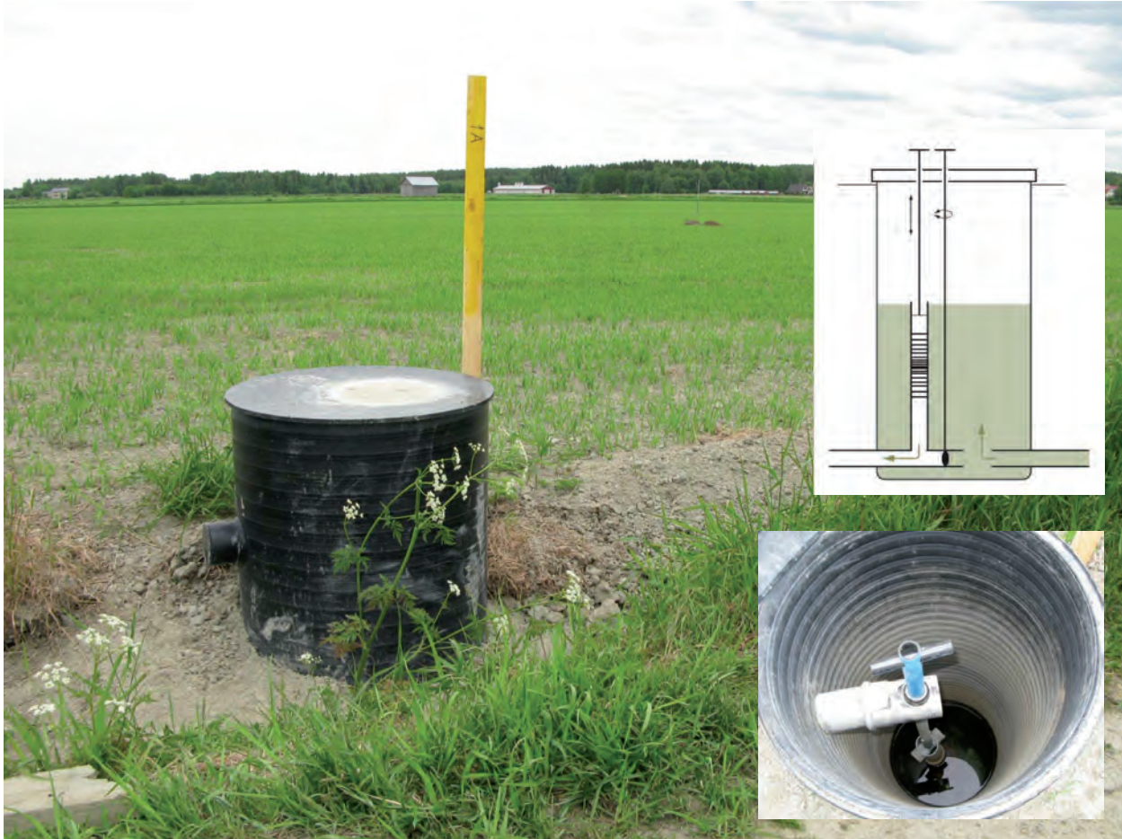
Kuva 9. Säättökaivo (Kuva: Rainer Rosendahl) ja sen periaatekuva (Lähde: Paasonen-Kivekäs 2009)
