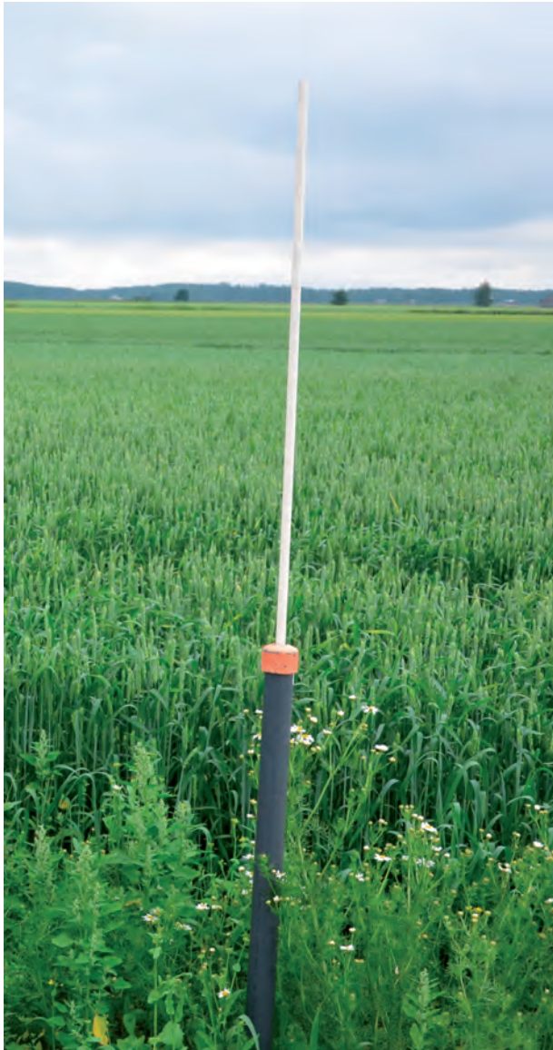
Kuva 10. Vasemmalla pohjavesiputki kelluvalla antennilla näyttää pohjavedenpinnan etäisyyden maan pinnasta (Kuva: Rainer Rosendahl). Oikealla pohjavesiputken periaatekuva (Lähde: Paasonen-Kivekäs 2009).
