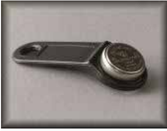
Kuva 2. A-Lab Oy:n markkinoima A-Nap, omalla paristolla varustettu lämpötilan mittauslaite, jonka tallentamat lämpötilatiedot voidaan siirtää lukijalaitteen avulla PC:lle. (Kuva: www.a-lab.fi )
