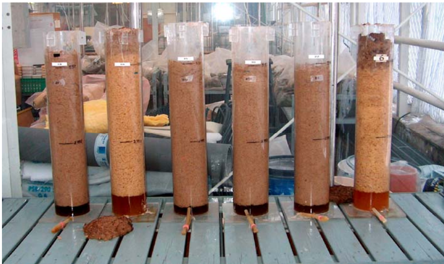
Kuva 9. Koejärjestelyt säilyvyyskokeessa. 0-käsittelyt ovat oikealla oleva lieriö sekä toinen vasemmalta oleva lieriö.
