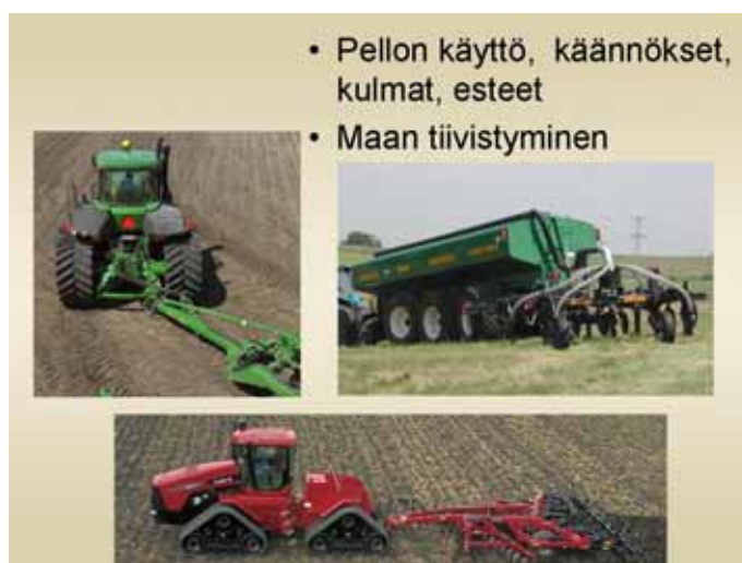
Kuva 23. Suuret koneet vaativat enemmän tilaa, jolloin osa pellostä saattaa jäädä viljelemättä. Maan tiivistymistä voidaan estää varustamalla suuret traktorit sekä vilja- ja lantavaunut kumiteloilla.
