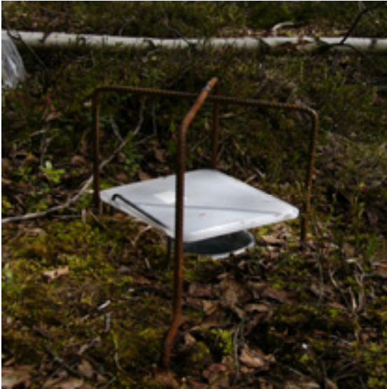
Kuva 2. Kuoppapyydykseen pyyntivalmiina. Kuvassa näkyy pyydysastia maahan upotettuna ja sen päällä vesikatos ja harjateräksestä taivuteltu suoja. (Kuva: Riku Halmeenpää)
