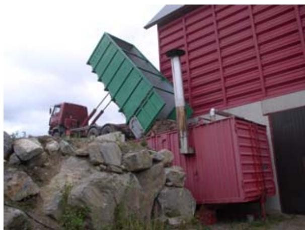
MTT:ssä kehitettiin perinteistä riihikuivausta jäljittelevä menetelmä. Siinä pakettikuivaamoon liitettiin hakekäytöinen lämpöyksikkö ja osa polttokaasuista johdettiin viljan joukkoon kuivauksen aikana.
