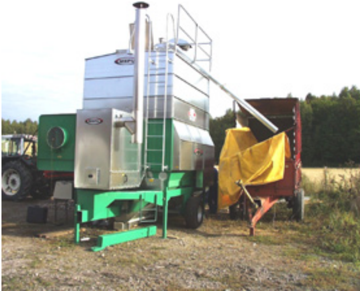
Kuva 30. Usein laajentavan tilan ei kannata uusia koko viljan varastointiketjuun, vaan hankkia lisää kapasiteettia olemassa olevan rinnalle. Joskus tuoresäilöntä sopii tähän, joskus esimerkiksi kuvassa oleva vaunukuivuri. (Kuva: Pasi Suomi)
