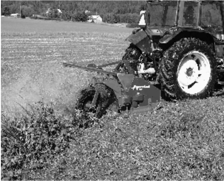
Kuva 19. Kelaniittokone on tehokas väline viherkesannon hoitoon. (Kuva: Timo Lötjönen)
