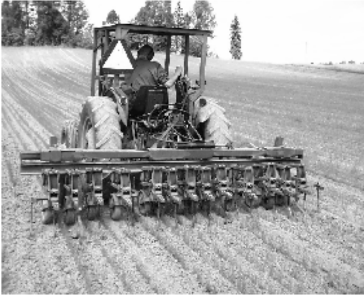
Kuva 22. 18 cm:n rivivälein kylvetyn öljypellavan riviväliharausta MTT/ Vako- lan kehittämällä haralla. (Kuva: Timo Lötjönen)
