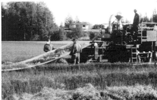
Öljypellavan puintitappioiden määrittämisessä puidaan talteen kerätty olki uudelleen laitoksen rakentamalla jälkipuimurilla.
