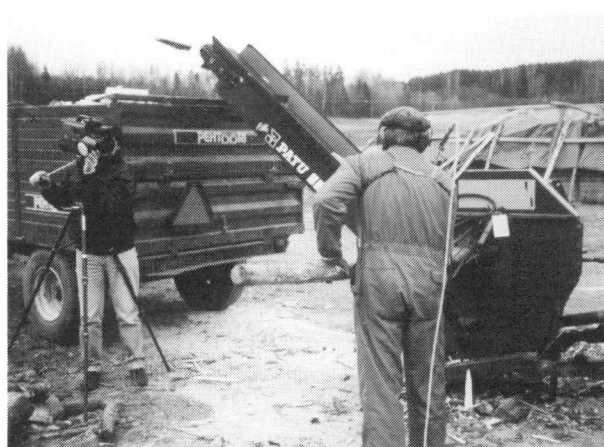
Pilkkomakoneiden turvallisuutta tutkittiin käytännön koeksissa puita pilkkomalla. Samalla tarkistettiin koneiden melutaso. Koneen toiminta myös videoitiin myöhempää tarkastusta varten.
