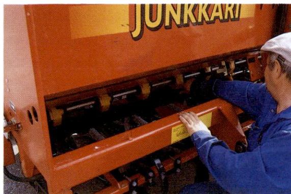
Kuva 9. Simultalla voidaan tehdä sekä siemenen että lannoitteen kiertokoe kiertokoekaukaloihin.
