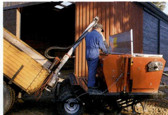
Kuva 8. Tavallisesta perävaunusta saa täyttöruuvilla avulla edullisen, turvallisen ja käyttökelpoisen täyttövaunun.
