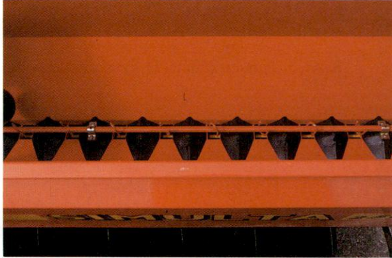
Kuva 6. Säiliön pohjakartioista on hyötyä varsinkin piensiemeniä kylvettäessä.
