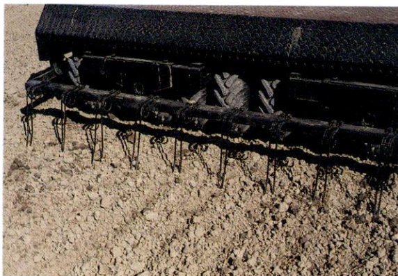
Kuva 16. Jyräpyörästä takana oleva jälkihara levittää pyörien väliin jäävät maavallit pyörien jälkiin.
