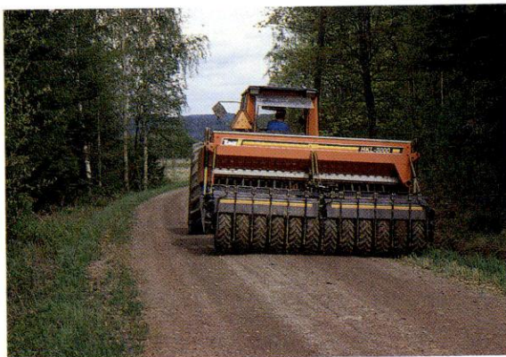
Kuva 17. Pieni kuljetusleveys on jyräkylvölannoittimen suurimpia etuja.
