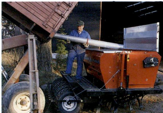
Kuva 7. Jyräkylvölannoittimen täyttö korkealta kippaavasta perävaunusta ei aina onnistu.
