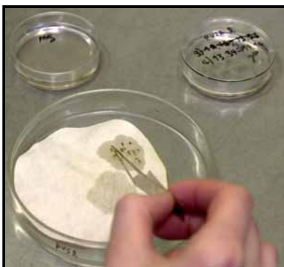
Kuva 5. Silmut nostettiin vitrifikaatioliuosten välillä imupaperille.
