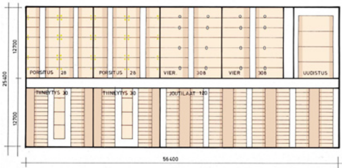
Kuva 54. 200-paikkainen emakkosikala, rakennuksen leveys on 25,4 m ja kerrosala 1432 m 2 . Eläinryhmät on osastoitu kiintein väliseinän. Rakennuksen pituussuuntainen keskiseinä voi olla kantava ja samalla palo-osastoiva seinä.
