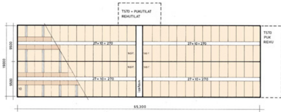
Kuva 56. 1080-paikkainen lihasikala ja kerrosala 1240 m 2 . Toiminnallisuus perustuu keskikäytäväratkaisuun, jolloin rakennuksen keskilinjan pituussuuntainen seinä voi toimia kantavana seinänä. Poikittainen keskiseinä voi toimia palo-osastoivana seinänä. Rakenteena voidaan käyttää kolminivelkehää joko korkeana sisätilana tai vaakasuoralla alakatolla. Toinen rakennukseen sopiva rakenne on puisella vetotangolla varustettu ansasrakenne, jossa vaakasuora ja samalla eristetty katto syntyy alapaarteena toimivan vetotangon tasoon.
