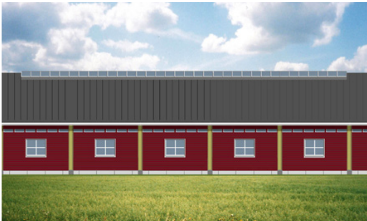
Kuva 72. Sama pilarihalli, mutta koko seinärakenne on toteutettu puurakenteisena joko paikalla rakentaen tai elementtinä. Ikkuna-aukotuksen määrä, muoto ja sijoitus on kevyessä puuseinäelementissä lähes vapaata. Eläinten turvallisuus on tietysti otettava huomioon niin, etteivät ne pääse kosketuksiin lasipintojen kanssa.
