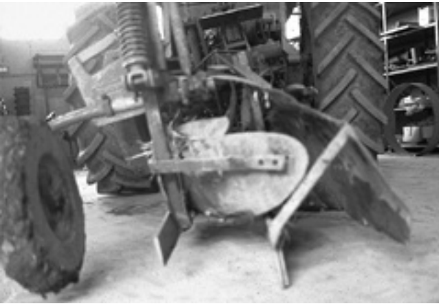
Kuva 2.3. Ruokamullan syvämultauksessa käytetty aura (kuva: Into Saarela).
