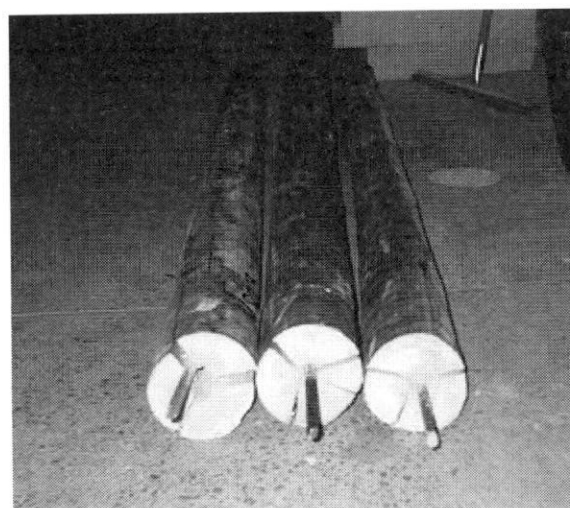
Kuva 19. Harjateräskoekappaleita sivusuuntaisen voiman kestävyyskokeen jälkeen.
